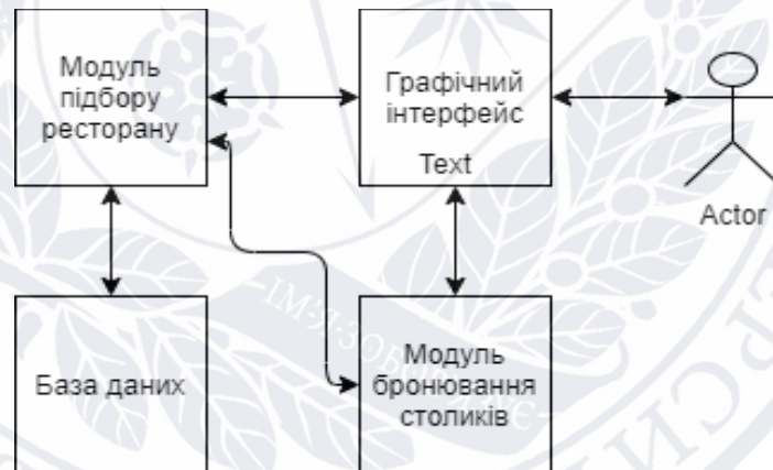
Рисунок 3.4 - Архітектура додатку для вирішення задачі резервування місць у закладах харчування
