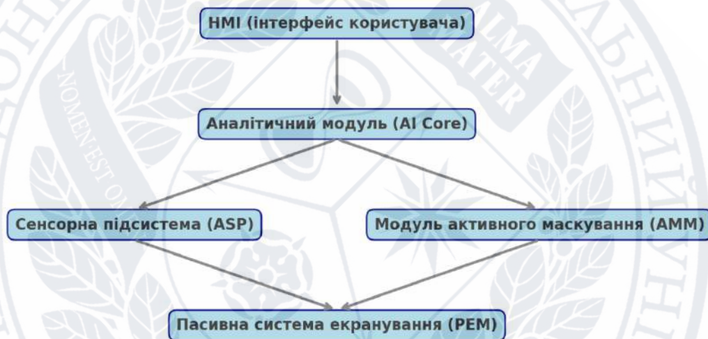
Рис. 4.1 – Архітектура гібридної системи захисту мовної інформації в салоні автомобіля
