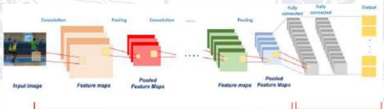
Рисунок 2.1. Проста архітектура CNN.
