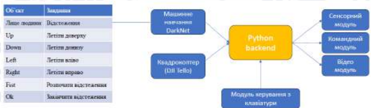
Рис. 3.9 – Структурна схема програмного модуля управління дроном DJI Tello
