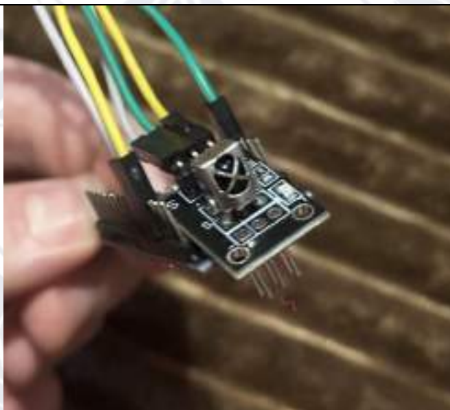
Модуль інфрачервоного приймача KY-022 який підключений до плати Slave 1
