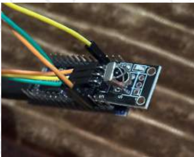
Модуль інфрачервоного приймача KY-022 який підключений до плати Slave2
