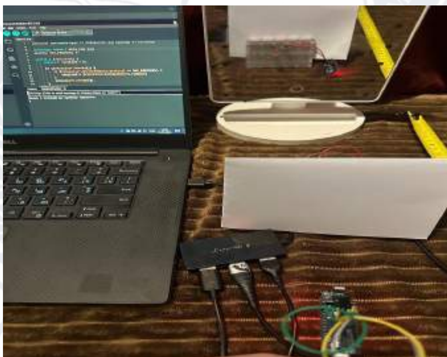
Рис. 3.5 - Плата Slave розташована за загорожею з листа A4 — сигнал не приймається
