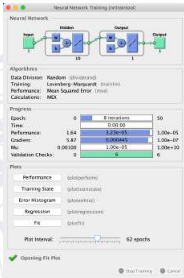
Рис 3.15 Представлення схеми навчання простої рекурентної нейронної мережі
