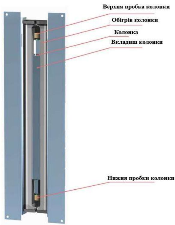
Рис.2.3 Будова колонки аналізатора ААА 500
