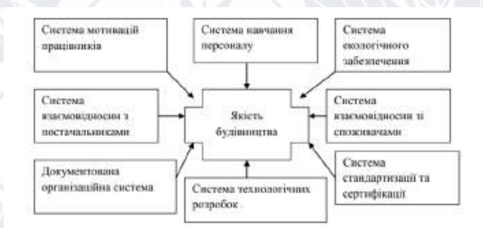
Рисунок 2.3 — Система якості будівництва
