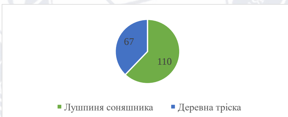
Рисунок 2.19 - Сировинна структура потужностей ТЕС та ТЕЦ на біомасі у 2023 році, МВт
