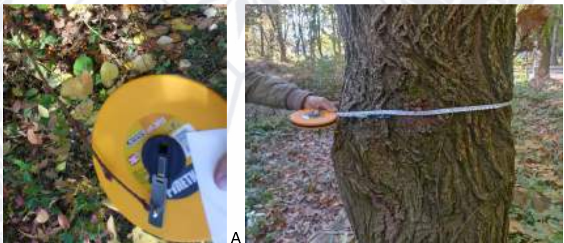
Рисунок 2.1. Інструмент для вимірювання (А) та вимірювання окружності стовбура дерева за допомогою рулетки (Б).
